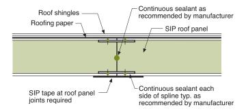
DETAIL 1.4: SIP ROOF - I-JOIST SPLINE JOINT<sup>10</sup>
